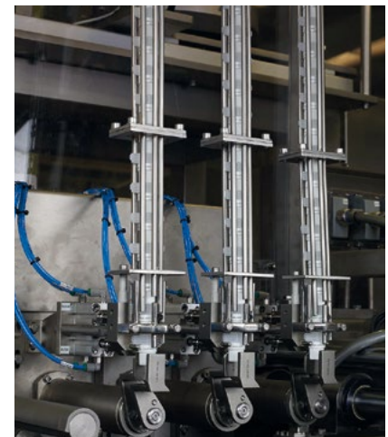
Guide rails and sequential grouping to feed valves with servo-controlled valve insertion finger clamps. Guías y grupos paso a paso para alimentación válvulas con pinzas de inserción válvulas accionadas mediante servo.
