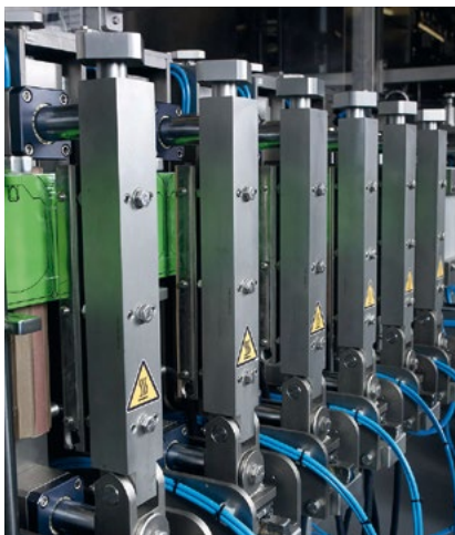
Parallel motion vertical sealing bars. Zona soldaduras verticales con sistema de movimiento en paralelo.
